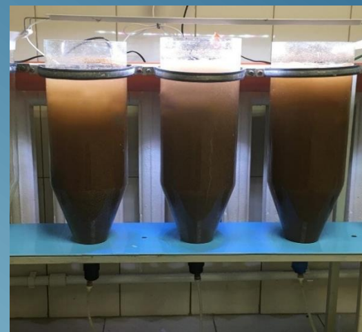
Рисунок 3. Инкубация цист артемии в аппаратах «Вейса»
